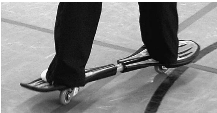
Abb. 3: Lenkung durch Belastung der Zehen und Ferse
